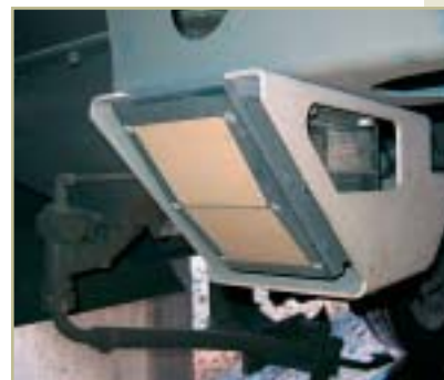
DRS 05 UNTER DEM WAGENKASTEN EINES SCHIENENFAHRZEUGS
